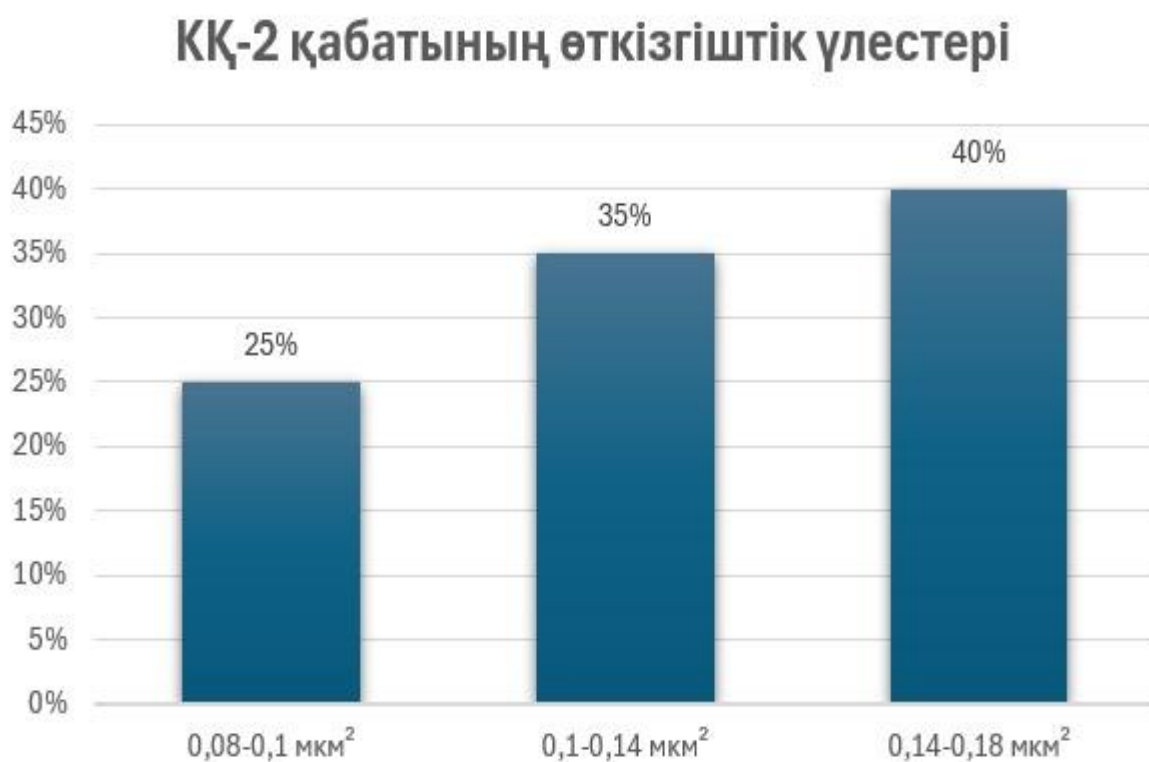
8- диаграмма – Жаңажол кен орнындағы КҚ-2 қабаттарының коллекторларының өткізгіштік қасиеттері
